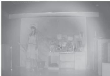
La Figure 4 montre les effets d'un petit morceau de carton se trouvant à une dizaine de centimètres à côté de la caméra. Même s'il n'est pas visible à l'image (le carton se trouve en dehors du champ de vision de la caméra), l'effet est énorme. Pour éviter cette situation:
