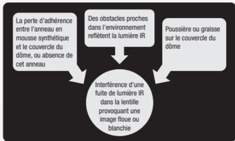
Un cas extrême de reflet IR est provoqué par l'ANNEAU EN MOUSSE qui n'est pas correctement fixé contre le dôme de la caméra. Ceci provoquera un effet « HALO BRUMEUX » (Figure 3).
